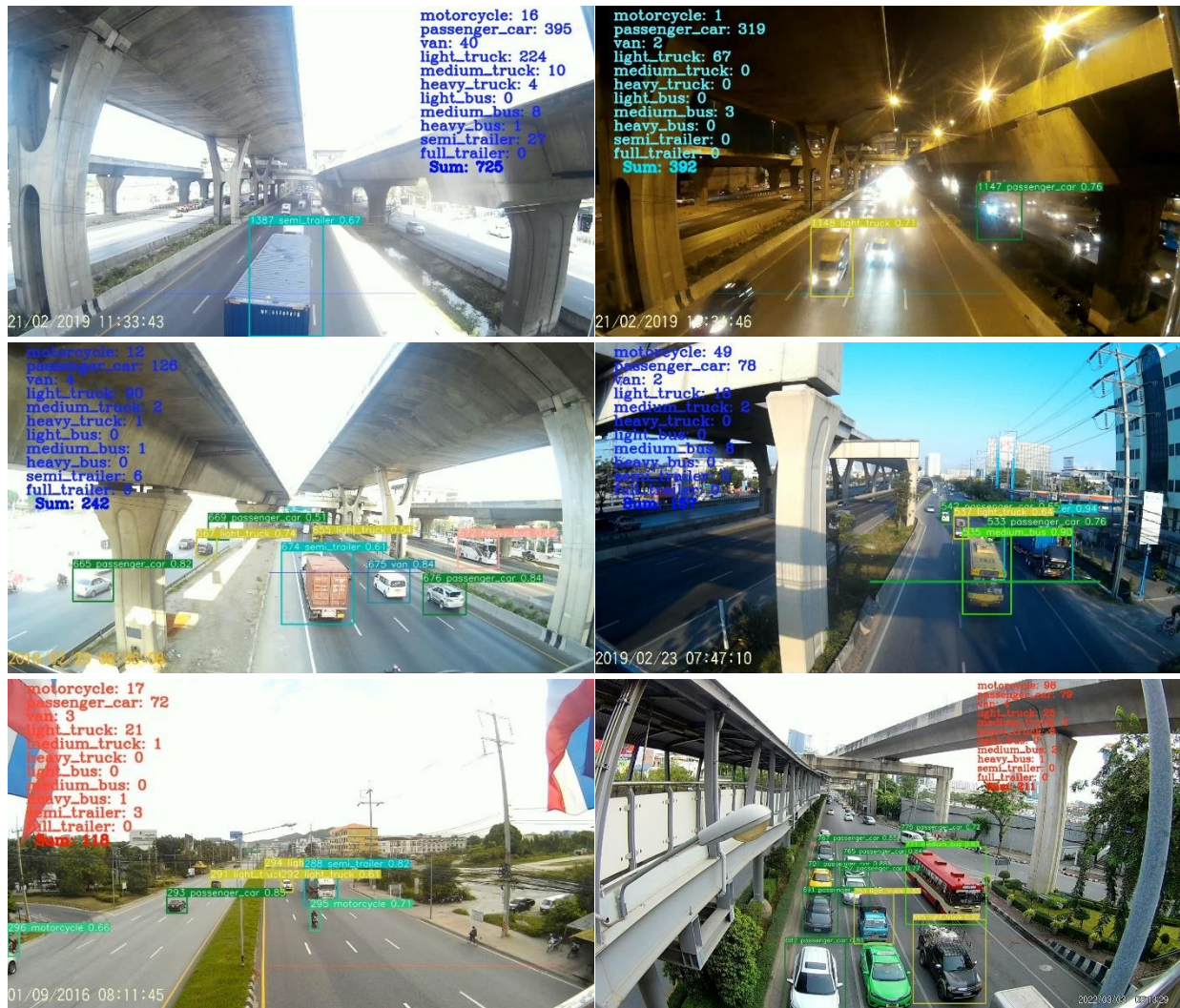
ภาพประกอบที่ 8 ตัวอย่างผลลัพธ์ที่ได้จากการทำงานของระบบนับและจำแนกประเภทยานพาหนะที่นำเสนอ
