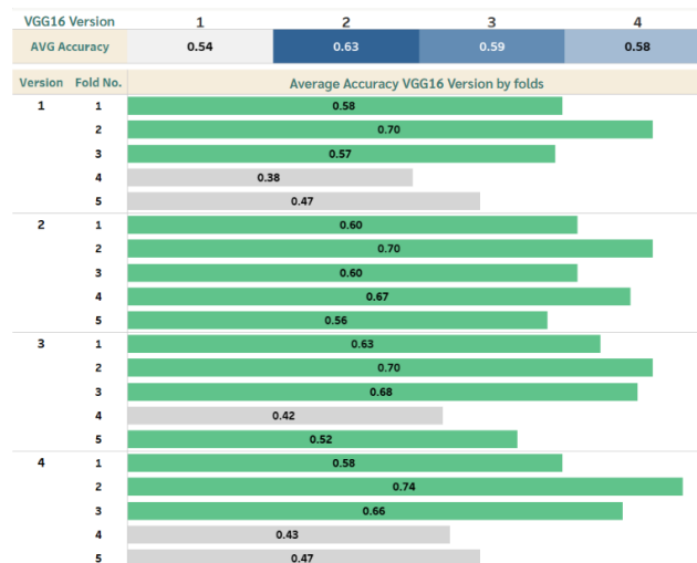
ภาพประกอบ 6 สรุปผลการประเมินประสิทธิภาพแบบจำลองด้วยอัลกอริทึม VGG16
