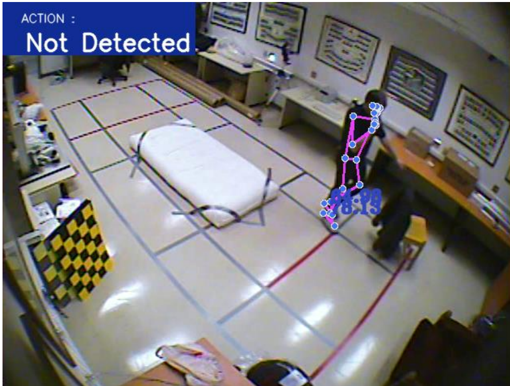
ภาพประกอบ 4 การตรวจจับการล้มโดยใช้การเปลี่ยนแปลงองศาของร่างกาย (มุมสะโพก-ข้อเท้า-เส้นพื้นดิน)
