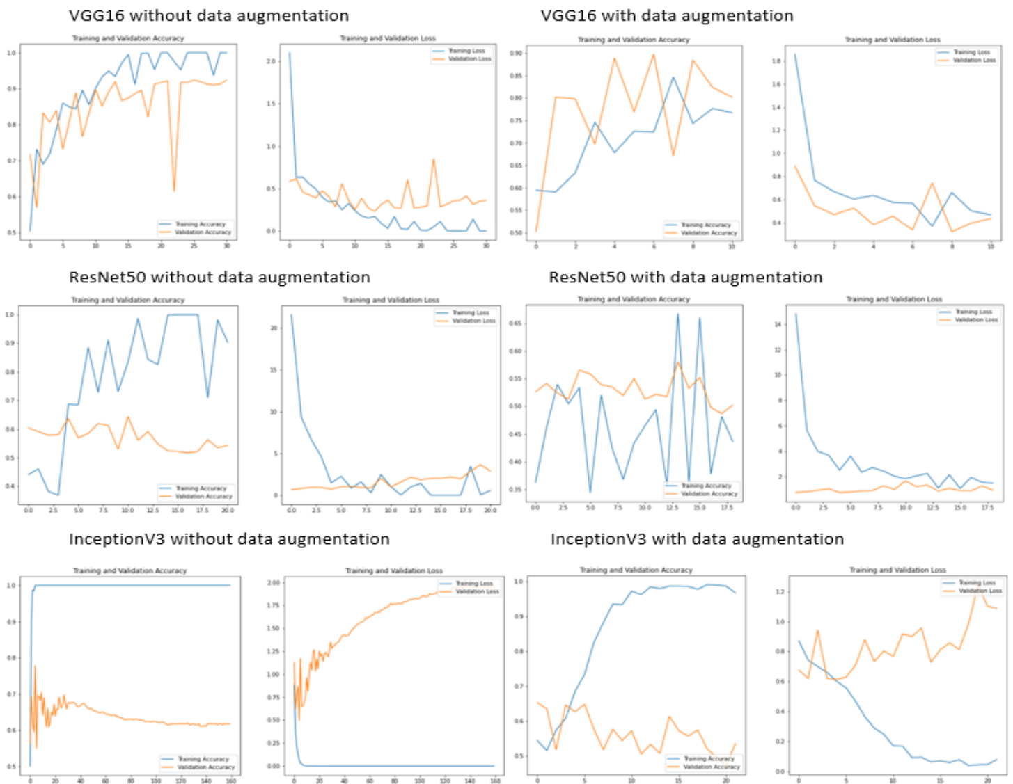
ภาพที่ 11 กราฟแสดงความสัมพันธ์ระหว่าง accuracy และ loss กับ epochs ของโมเดล fine tune ทั้ง 6 โมเดล
